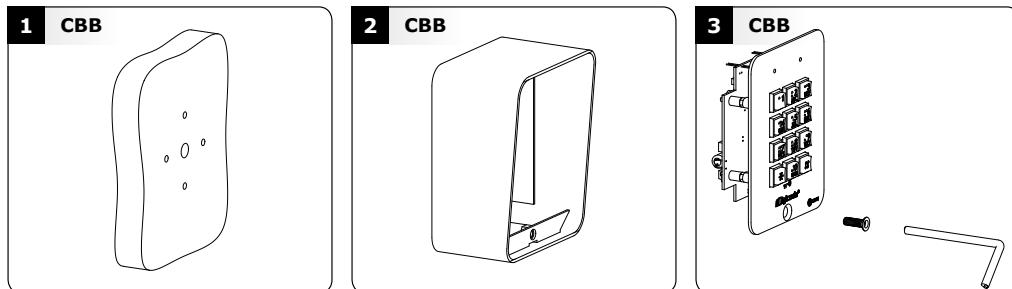
Neem de opbouw behuizing om de bevestigingsgaten te meten en te markeren. Boor daarna de 4 bevestigingsgaten en de bedradingstoegang.
