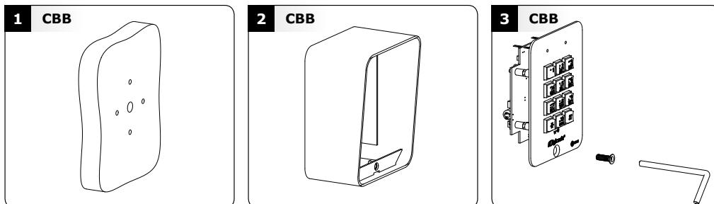
A l'aide du Digicode®, prenez les marques et percez les 4 trous de fixation ainsi que l'ouverture pour le passage du câble électrique destiné au clavier.
