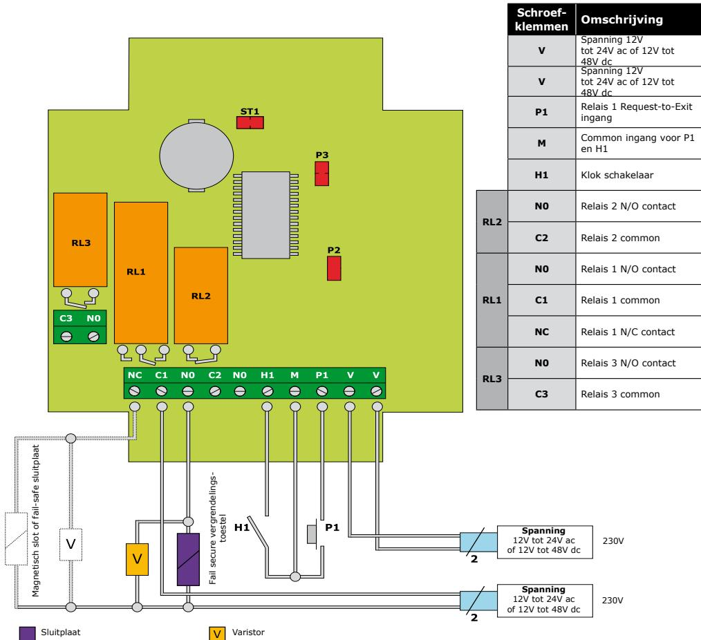
**P2** : Reset**P3** : Schakelt de optie wijziging van gebruikerscode door gebruiker in of uit.**ST1** : Audio feedback jumper. Verwijder om de audio feedback uit te schakelen.**Dit product wordt geleverd met een varistor.**
