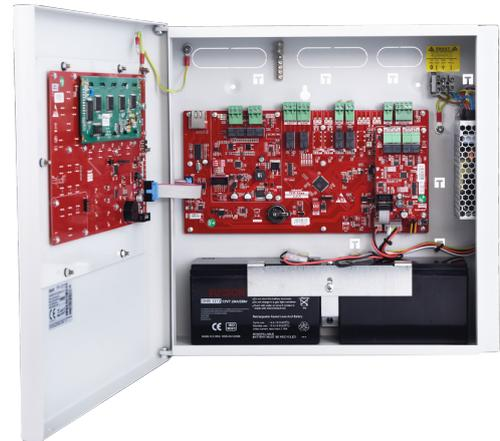
Le panneau de commande adressable TFP-1214 utilise le protocole unique FLASHLINK pour la communication avec la boucle, développé par les ingénieurs de Teknim. Il prend en charge 4 boucles, 508 dispositifs (jusqu'à 127 par boucle) et un réseau de 16 panneaux de contrôle au maximum. Il s'agit d'une solution stable et fiable.
