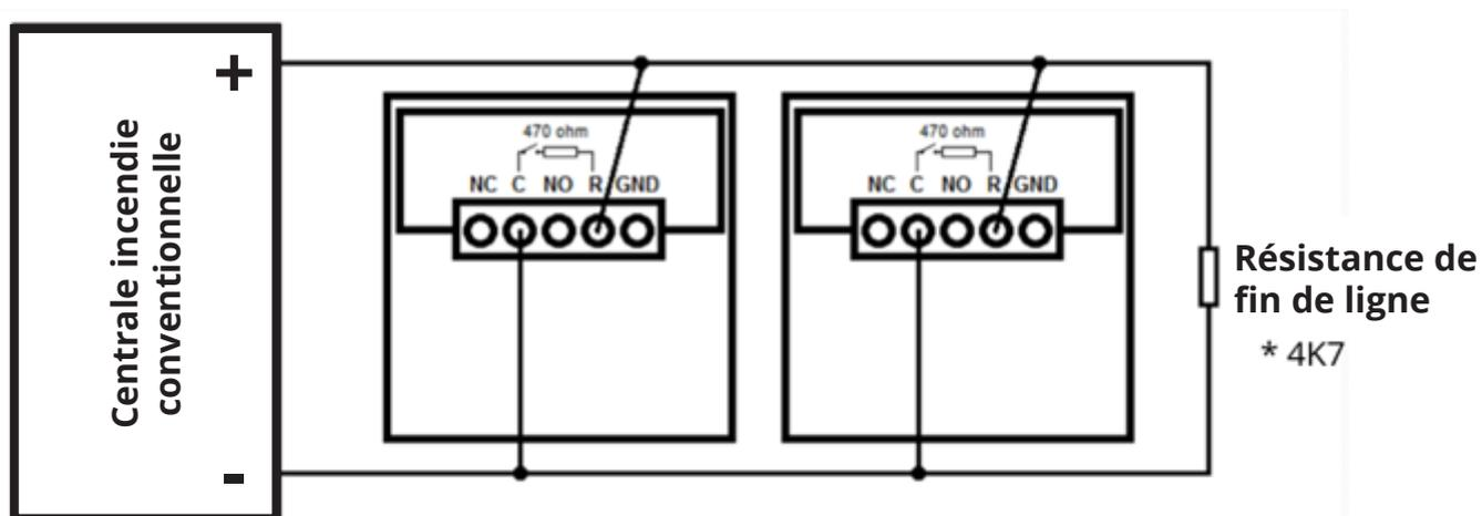
**3** Les sirènes sont connectées aux bornes de sortie des sirènes.
