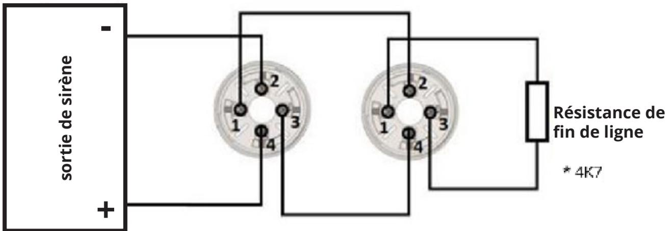
Chaque zone doit être terminée par une résistance de fin de ligne de 4K7 Ohm !\*.
