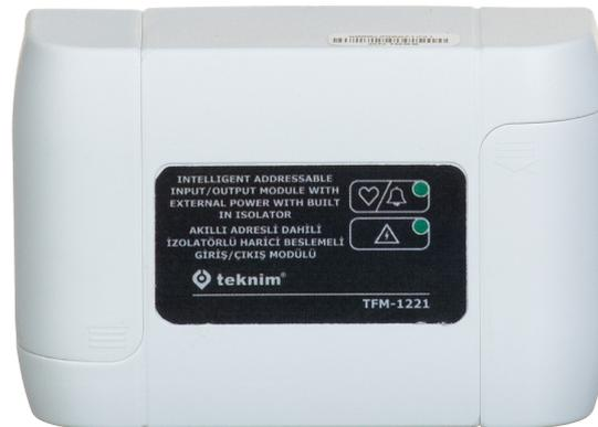
Le TFM-1221 dispose d'une seule entrée surveillée et d'une seule sortie qui prend en charge la connexion d'une alimentation externe et permet de connecter, par exemple, des transmetteurs de signaux conventionnels aux unités de commande adressables de la série TFP-12XX. L'appareil dispose également d'un isolateur intégré pour protéger la ligne de boucle contre les courts-circuits.
