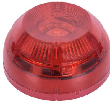
Le TFS-1183R est une lampe flash adressable et peut être connecté directement à la boucle. La lampe flash est alimentée par la boucle et possède un isolateur intégré pour protéger la boucle des courts-circuits. Le TFS-1183R prend en charge 3 modes de flash différents et des options de luminosité.
